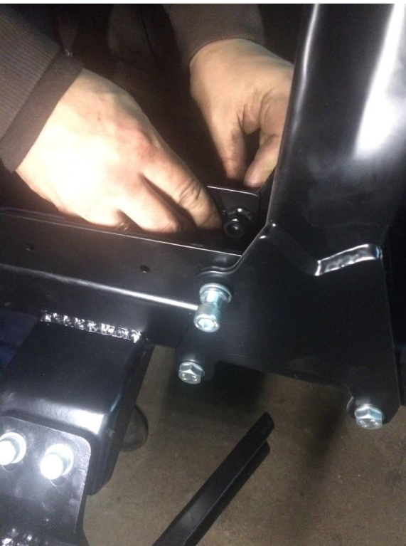
24. Если кронштейн запасного колеса с возможностью крепления хайджека и лопаты то, прикручиваем опору лопаты (2 болта М10х30 DIN912)
