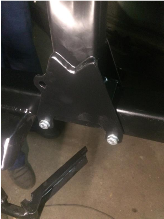
23. Фиксируем кронштейн запасного колеса на калитке (2 болта М10х85)
