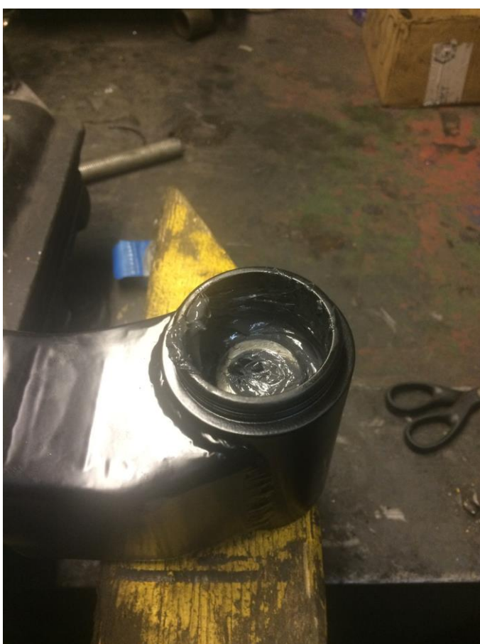
12. Смазываем и опускаем подшипник в обойму.
