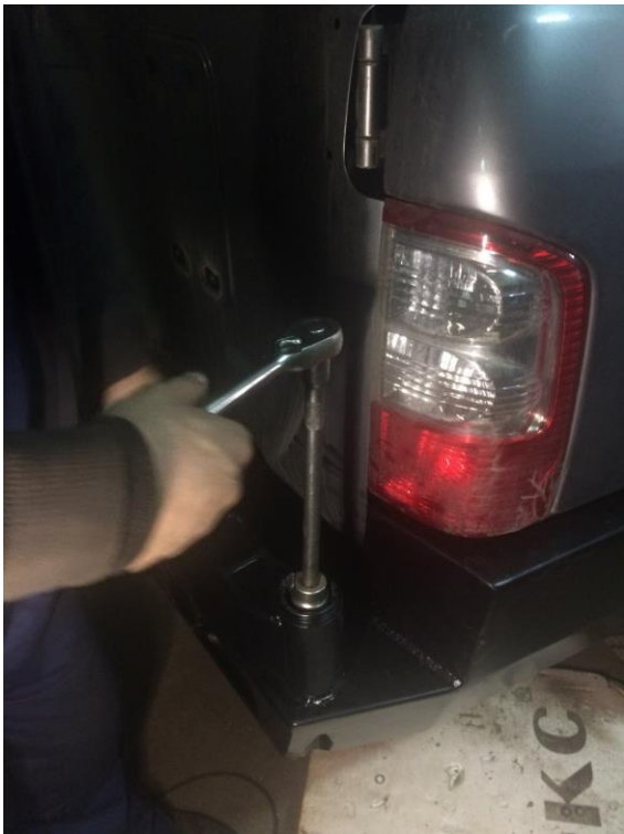
16. Фиксируем калитку гайкой М18х1.5.
