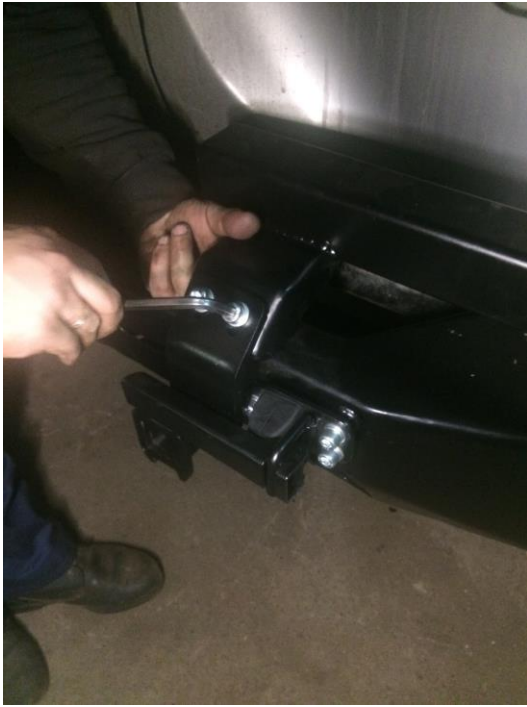
19. Прикручиваем замок на калитку (2 болта М10х30 DIN912)
