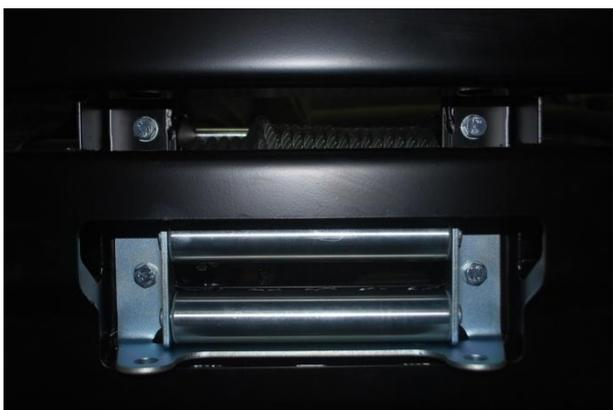
10. Затем необходимо развернуть редуктор лебедки, что бы открыть доступ к рычагу свободной размотки. Откручиваем редуктор, разворачиваем и закручиваем.
