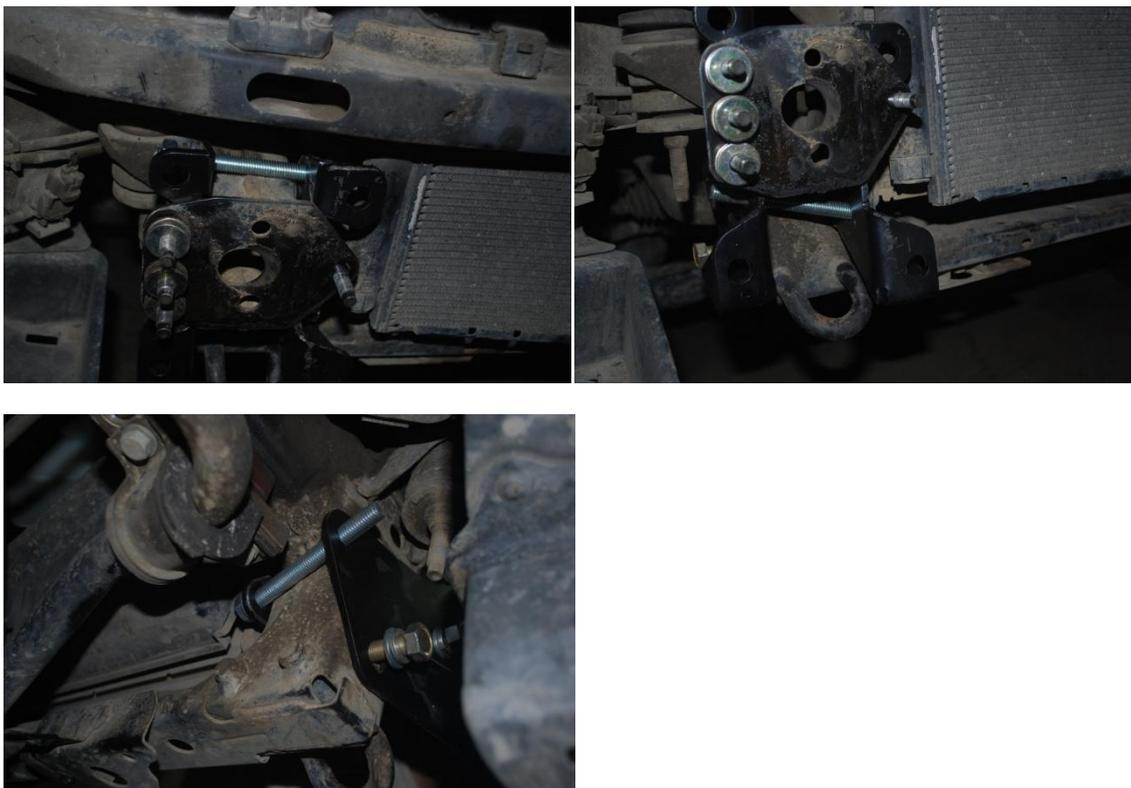
6. Закрепляем основной кронштейн на штатные шпильки рамы, а затем с помощью болтов М12 соединяем кронштейн с рамными обхватами, прикручиваем кронштейны к обхватам, затягиваем болты.
