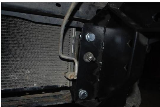
7. Замеряем расстояние по внешним щекам кронштейнов и внутренне расстояние щек на бампере, расстояние внешних щек кронштейнов должно быть чуть меньше, чем расстояние между щек на бампере.
