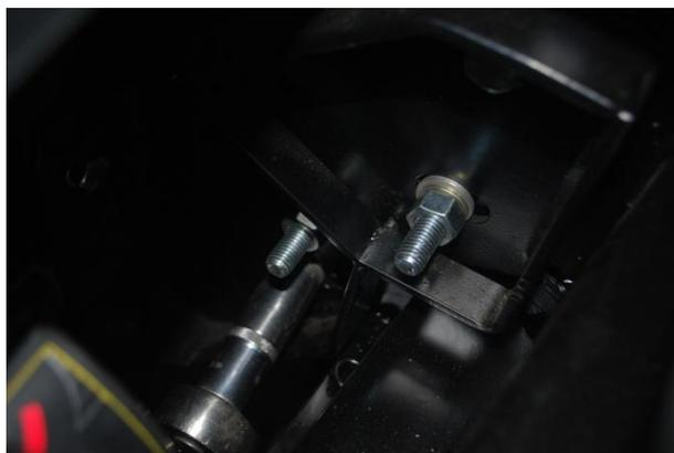
13. Регулируем бампер на кронштейнах. Между бампером, решеткой радиатора и крыльями по всей длине должно быть одинаковое расстояние. Регулировка возможна по горизонтали и вертикали, благодаря овальным отверстиям в щеках бампера, расположенным по вертикали и овальным отверстиям в кронштейнах, расположенным по горизонтали.
